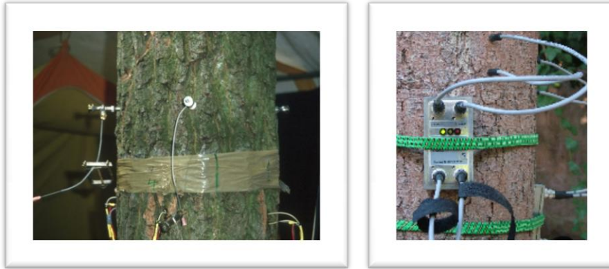
4.kép: Együttes mérések ugyanazon fán különböző módszerekkel. Legfelül az izotópos nyomjelző módszer injektálása, a leragasztott sáv az ultrahangos mérőfejeket takarja, a legalsó sor a hőáramlásos módszer mérőfejei.
