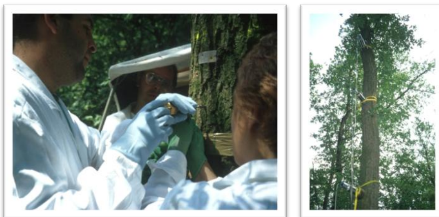
1-2. kép: Izotóp injektálása fatörzsbe; Ólommal borított szcintillációs detektorok a törzs mentén. Pictures 1-2. Radioactive isotope input and radiation measurement.
