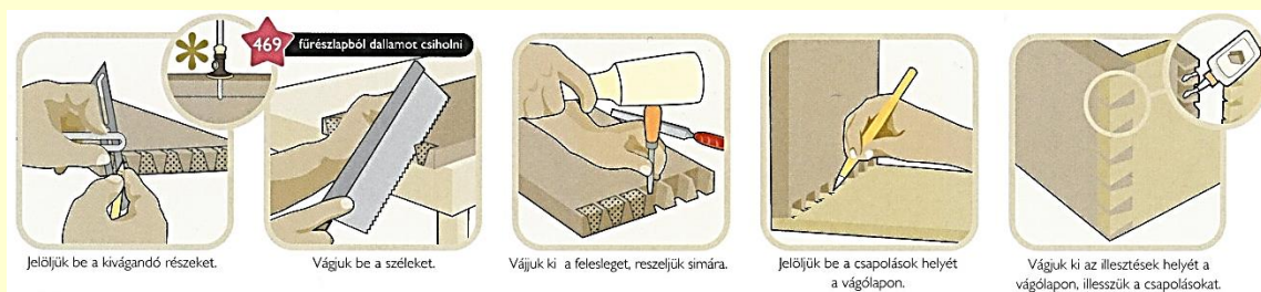
1. ábra: Fecskefarkú fogazás készítésének ábrázolása
