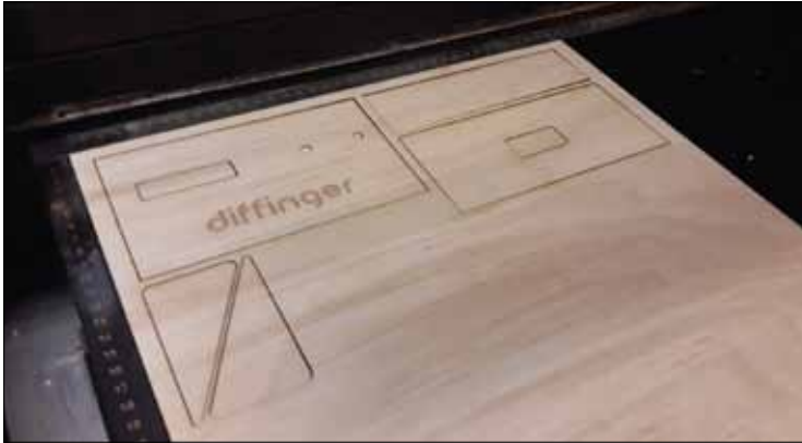
17. ábra. kezelőpanel lézerezése
