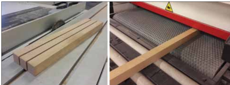
12. ábra. darabolás, kontaktcsiszolás
