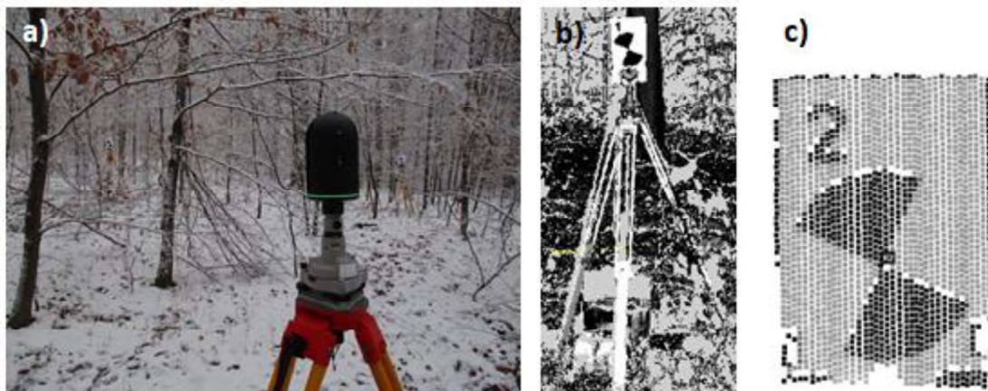
1. ábra. Téli felmérés Leica BLK360 lézerszkennelvel (a). Az állványra helyezett kapcsolójel intenzitás szerinti leképeződése a pontthalmazban (b), egy kapcsolójel közelről, amelyen látszik, hogy az intenzitásértékek a pontokhoz tartoznak (c)
