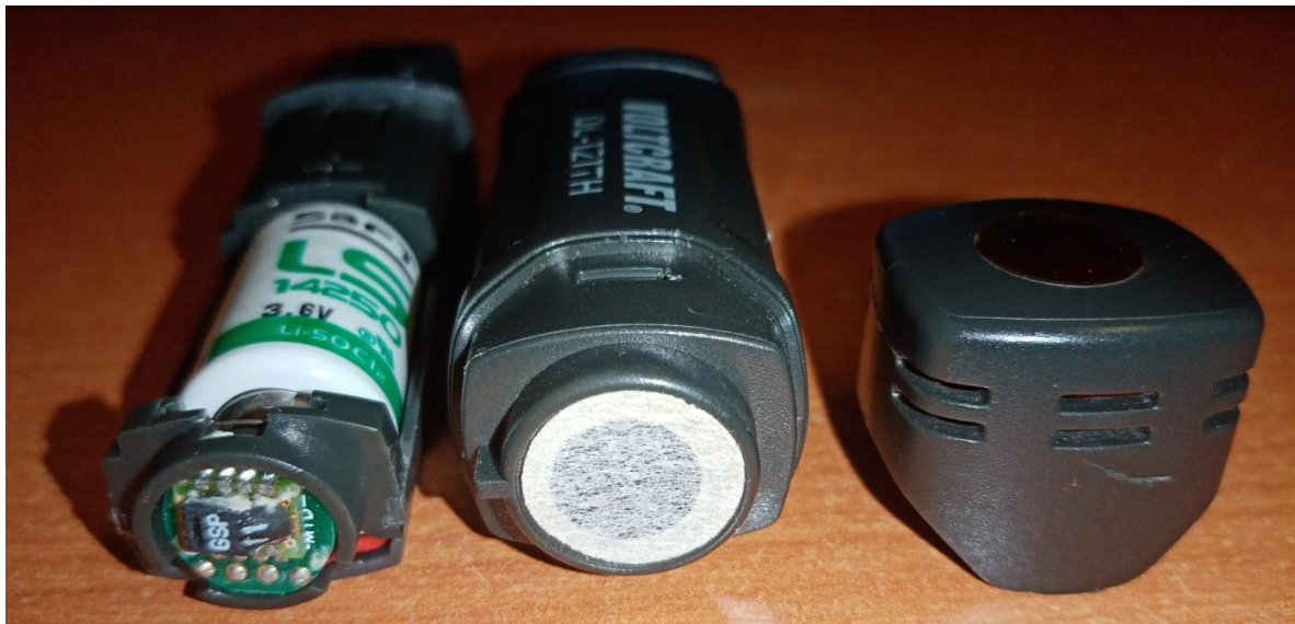
2. ábra Mérőegység, védőburkolat filc szövettel és zárókupak
