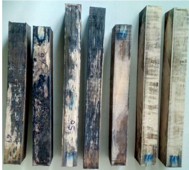
3. ábra Néhány kész mintatest (balról jobbra: tölgy szárazon hajlítható, tölgy nedvesen hajlítható, bükk szárazon hajlítható, bükk nedvesen hajlítható faanyag)
