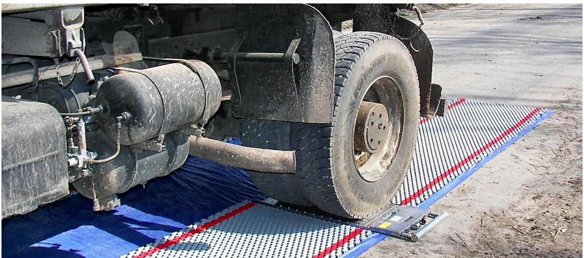
1. ábra Liaz tehergépkocsi kerékterhelés mérése erdőgazdasági úton (saját felvétel)
