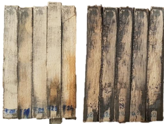
5. ábra Bükk és tölgy minták a tömörítést követően
