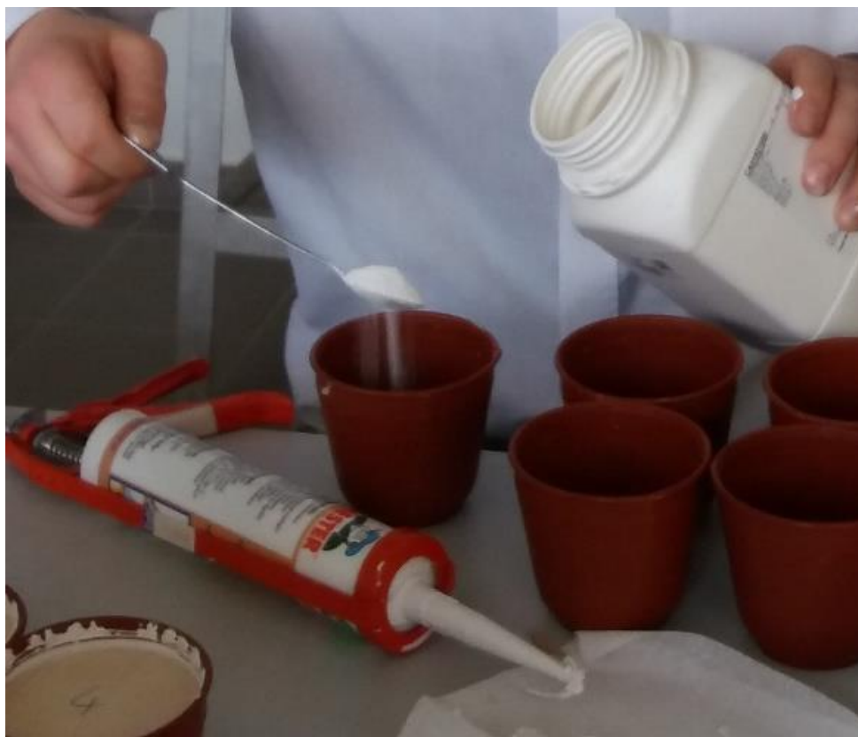
2. ábra Nedvszívó közeg létrehozása a páradiffúziós vizsgálatokhoz
