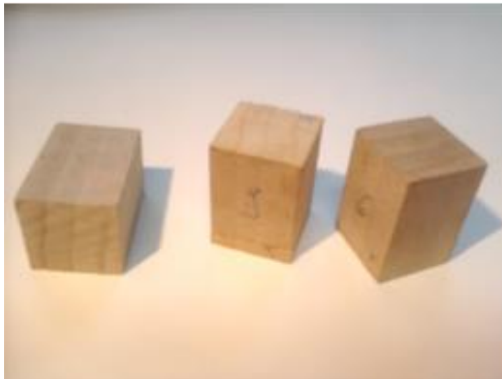
1. ábra Zsugorodás-dagadás mintatestek
