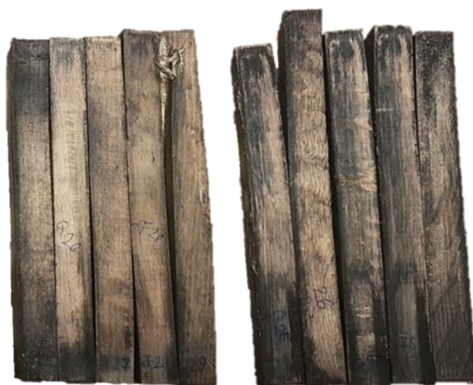
6. ábra Bükk és tölgy minták a tömörítést követően
