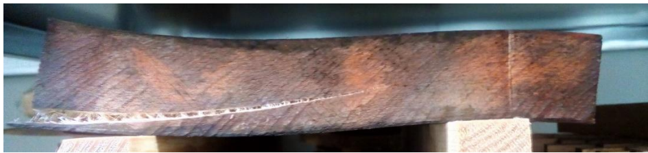
1. ábra Alátámasztásról leelő mintá berepedése és ferdeszálúság miatti tönkremenetele
