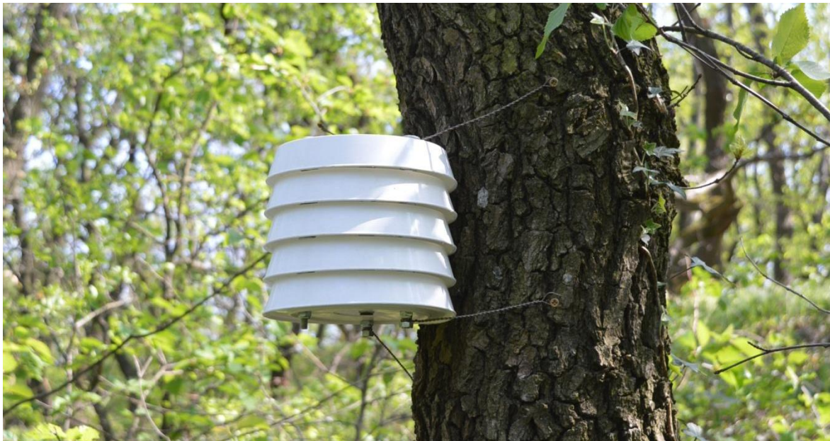
4. ábra Mérési ponton kihelyezett árnyaló
