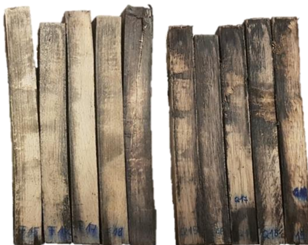
4. ábra Bükk és tölgy minták a tömörítést követően
