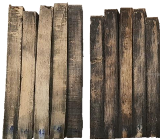
3. ábra Bükk és tölgy minták a tömörítést követően
