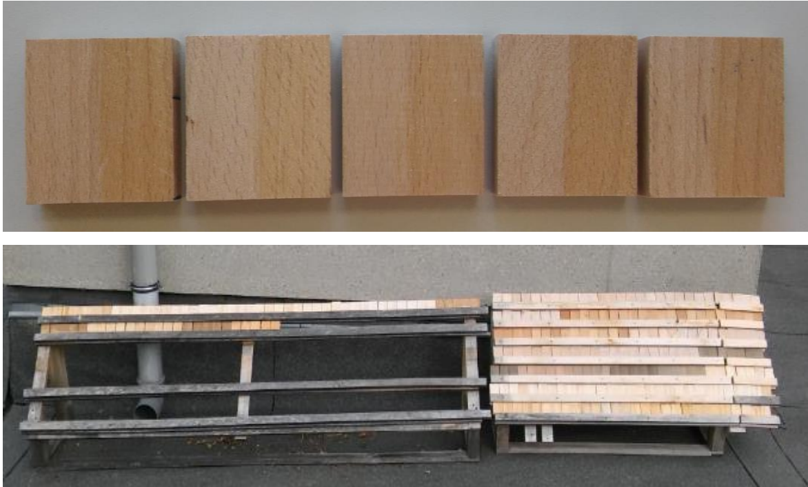
2. ábra Kétfunkciós mintatestek (fent) és kültéri kitettségi vizsgálat (lent)
