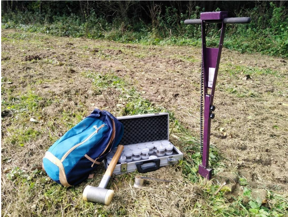
2. ábra Zavartalan mintavételhez használatos mintavevő készlet (középen) és a TDR műszer (jobbra) (saját felvétel)
