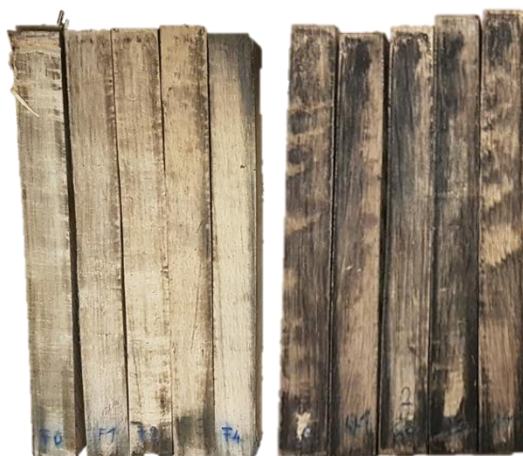
1. ábra Bükk és tölgy minták a tömörítést követően
