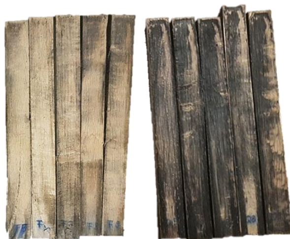
2. ábra Bükk és tölgy minták a tömörítést követően
