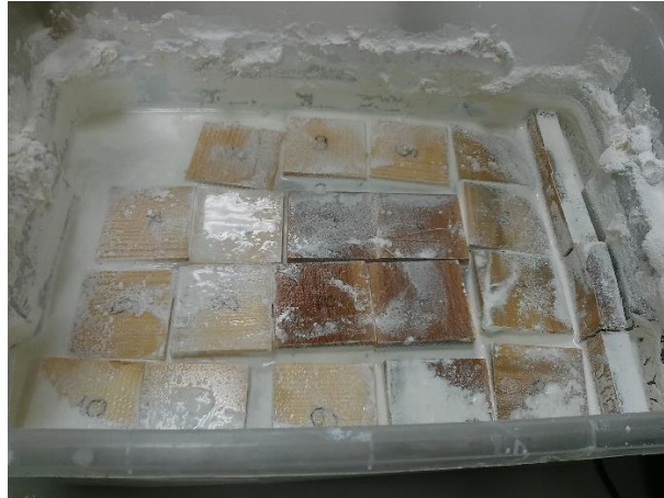
3. ábra A nanorészcsek kiülepedtek a próbatestekre
