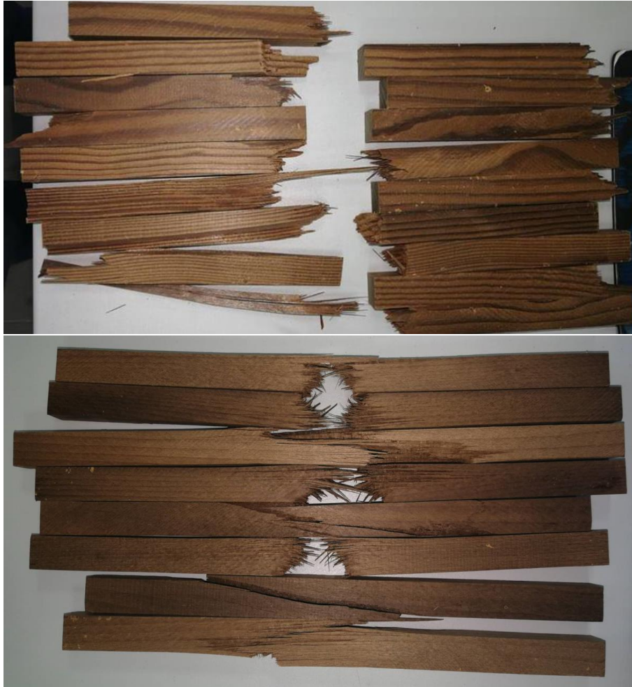
5. ábra 180 °C-on paraffinban hőkezelt erdeifenyő (fent) és bükk (lent) törési képei
