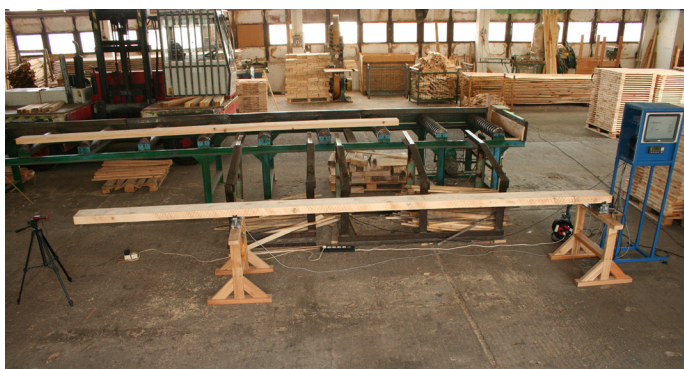
9. ábra: A PLG+ ipari környezetben használható fűrészáru osztályozó berendezés
