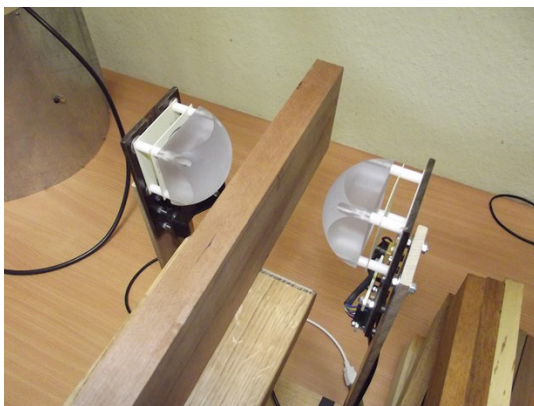
1. ábra: A fókuszáló lencsékkel felszerelt antennákból álló mérőrendszer fényképe és sematikus ábrája
