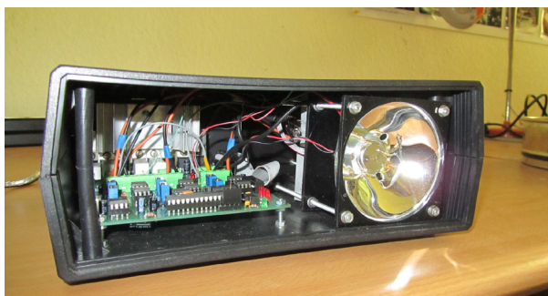
2. ábra: Az NIR lézer mérési összeállítás működési vázlatja és fényképe (1 – Elektronika; 2 – Áramforrás; 3 – Processzor; 4 – Parabola tükör; 5, 6, 7 – a, b és c dióda; 8 – Áramforrás hűtése; 9 – Diódák hűtése; 10 – Érzékelő dióda a parabolatükör fókuszpontjában; 11 – Soros kimenet)
