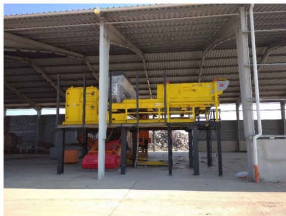
5. ábra: A STEINERT által gyártott PC2800R típusú optikai válogató. Forrás: Takács Krisztián felvétele
