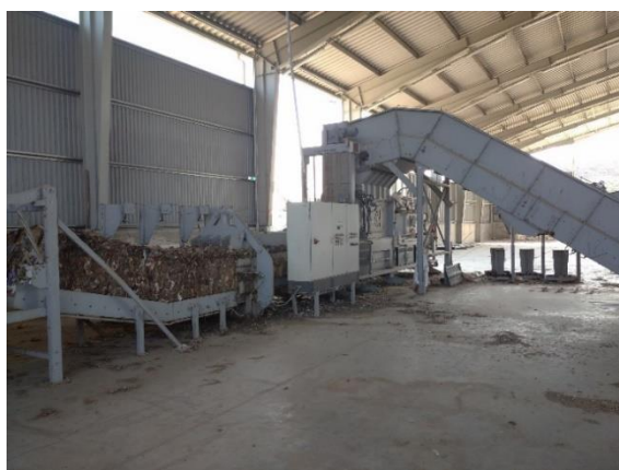
7. ábra: Az AVERMANN-HORVÁTH által gyártott AVOS-1810 55/80 típusú bálázógép. Forrás: Takács Krisztián felvétele
