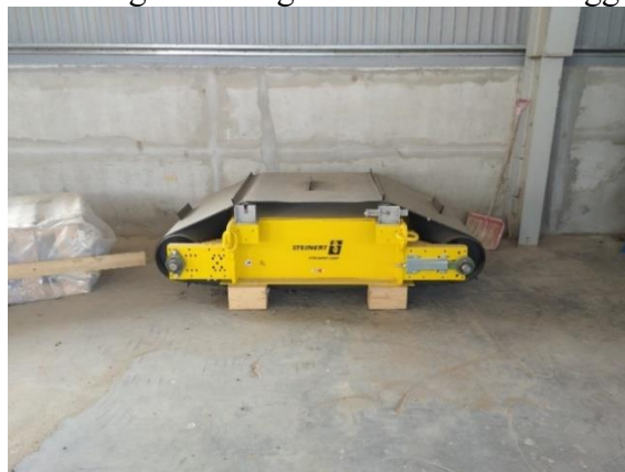
2. ábra: A Steinert GmbH által gyártott UME 95 110 C típusú mágnes szeparátor. Forrás: Takács Krisztián felvétele
