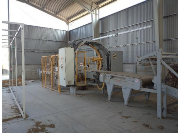
8. ábra: A Cross Warps LTD által gyártott Cross Warp 2200 LW-750-1/5 típusú bála csomagoló gép. Forrás: Takács Krisztián felvétele
