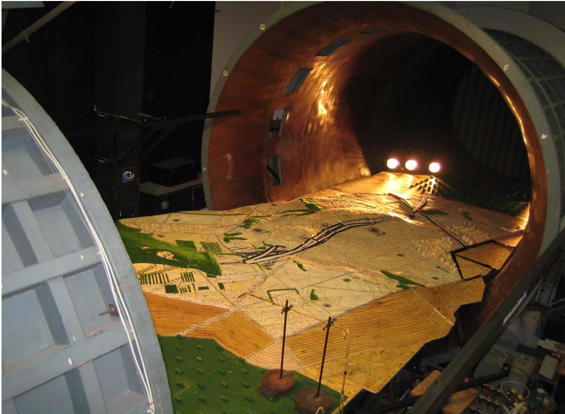
15. ábra: A vizsgálathoz alkalmazott szélcsatorna és terepmodell
