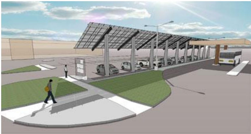
79. ábra: Napelemmel felszerelt töltő állomás 10 elektromos autó töltéséhez [6]
