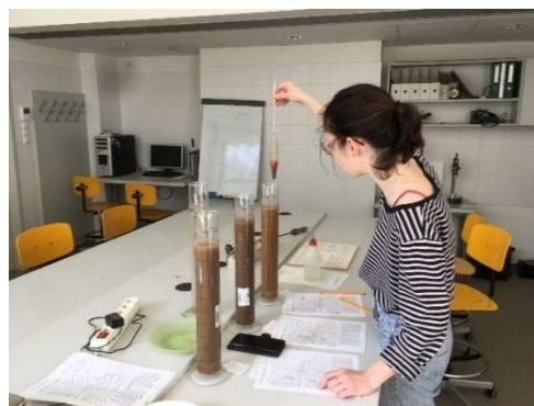
6. ábra. Hidrometrálás az egyetemi talajmechanika laborban
