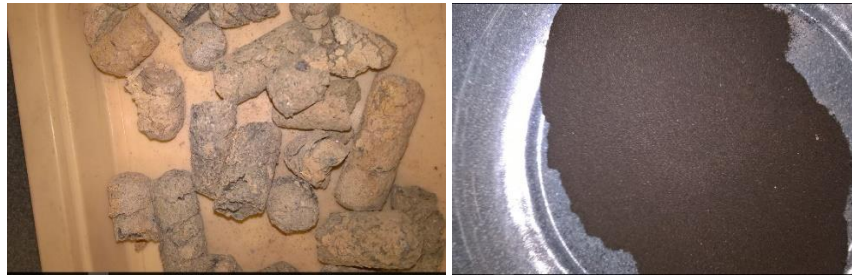
5. ábra: A pelletégetés salakja és pernyéje
