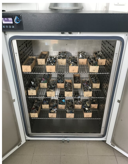
3. ÁBRA: A SZÁRÍTÓSEKRENY A BENNE LÉVŐ MINTÁKKAL FOTÓ: SAJÁT KÉSZÍTÉS
