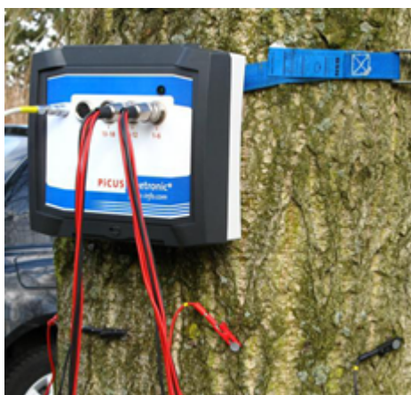
3.1. ábra: A PICUS Treetric mérőrendszer (Argus Electronic GmbH, 2017)
