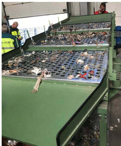
1. ÁBRA: SZEMCSEMÉRET OSZTÁLYOZÁSA (<20 MM, 30 MM, 40 MM, >40 MM) FOTÓ: SAJÁT KÉSZÍTÉS
