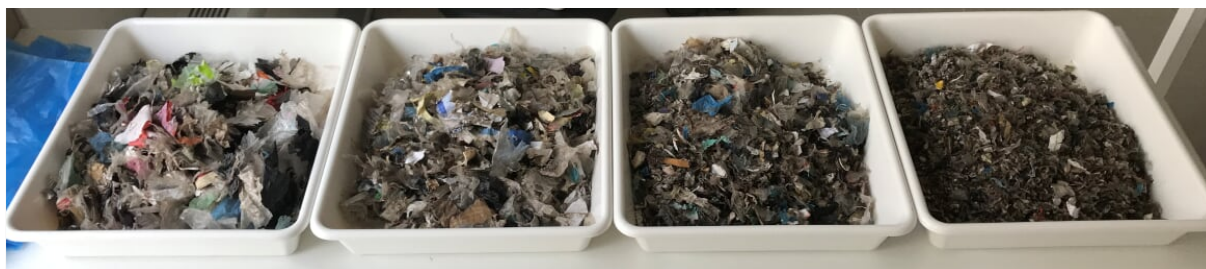
2. ÁBRA: SZEMCSEMÉRET FRAKCIÓK (>40 MM, 30-40 MM, 20-30 MM, <20 MM) MINTÁI FOTÓ: SAJÁT KÉSZÍTÉS
