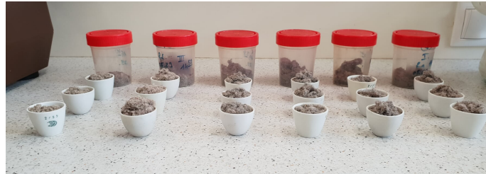
5. ÁBRA: <1 MM-RE APRÍTOTT MINTÁK A KERÁMIA CSÉSZÉKBEN FOTÓ: SAJÁT KÉSZÍTÉS
