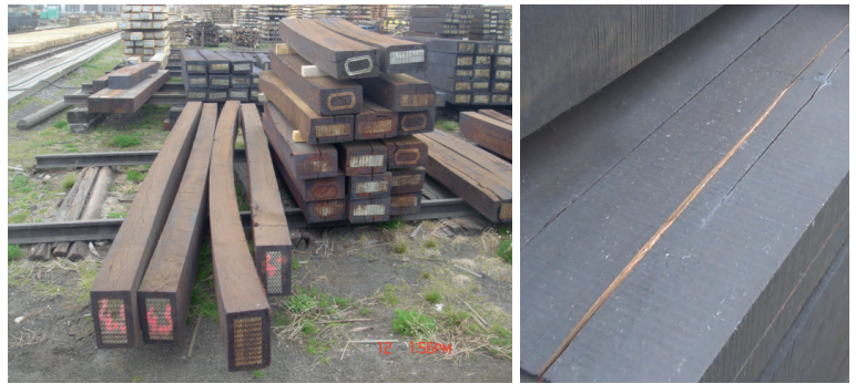
6. ábra: Telítés utáni görbült tölgy váltóalj (balra), nem megfelelő mélységű telítés utáni repedés (jobbra)
