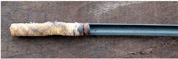
5. ábra: Növedékcsap telített tölgy váltóaljából
