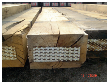
3. ábra: Nem elfogadható gyűrűs elválás a keresztmetszeten
