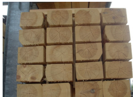
2. ábra: Elfogadható száradási repedések a keresztmetszeten
