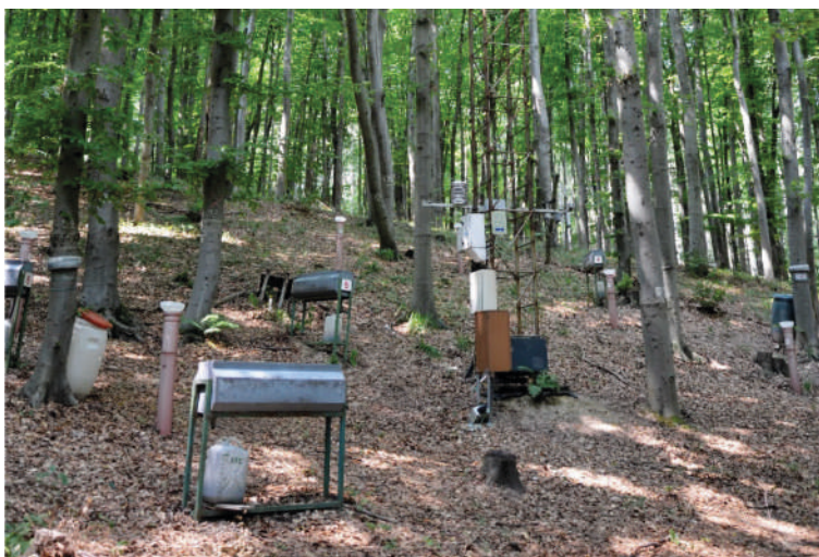
1.3.-8. ábra. Intercepció és állományklíma mérés a Soproni-hegység Új-Hermes melletti bükkösében (Fotó: Gribovszki Zoltán)
