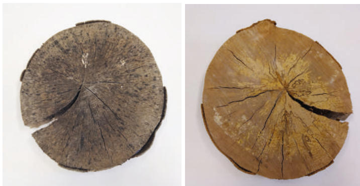
6.7.-13. ábra. Előrehaladott állapotú fülledés bükk faanyagon – márványosodás (Fotó: Horváth Norbert)
