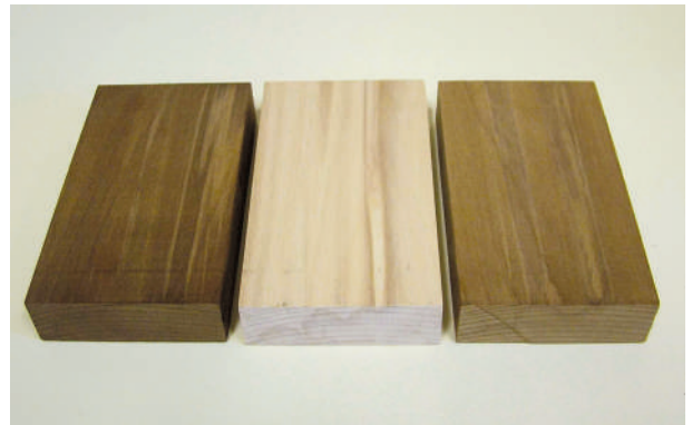
6.7.-14. ábra. A száraz termikus modifikáció színhomogenizáló hatása álgesztes bükk faanyagon (Fotó: Horváth Norbert)
