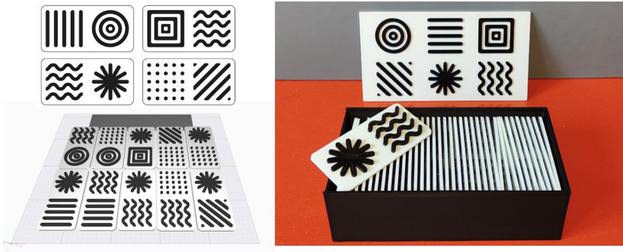
12. ábra. Szenzoros dominó a tervezés során és a 3D nyomtatott változata [4]
