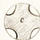
IV. ábra A földszóró henger keresztmetszete.
