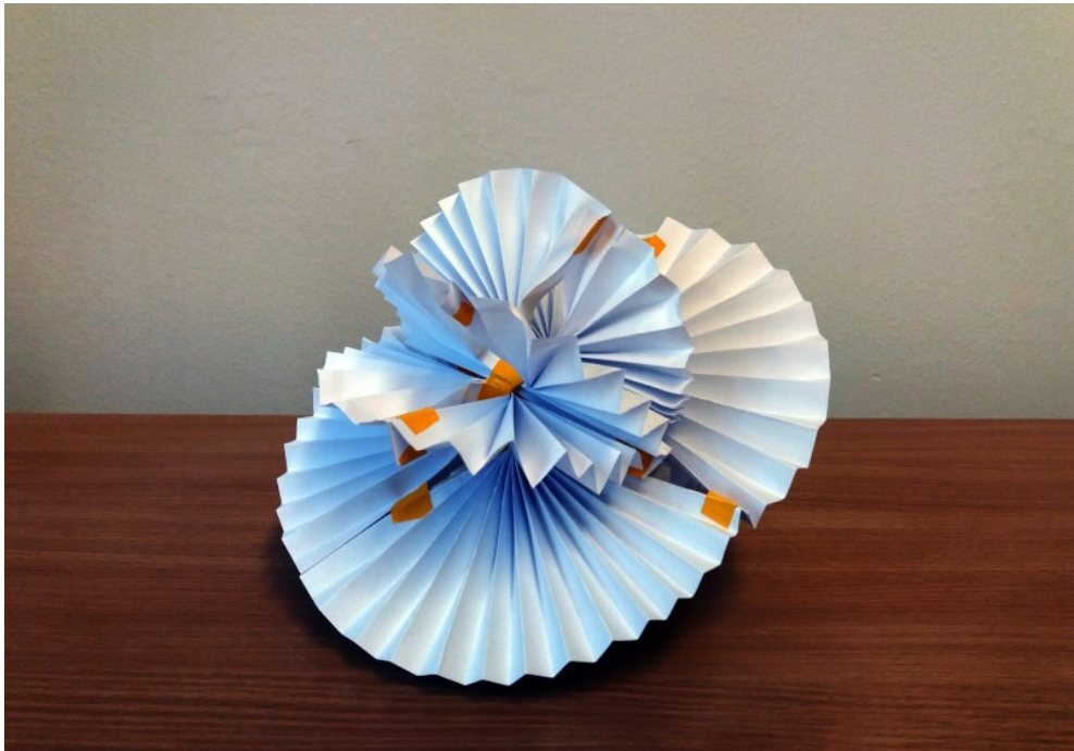
1. kép: Tojásprotektor fékezősárnyakkal és gyűrődőzónával fénymásolópapírból
