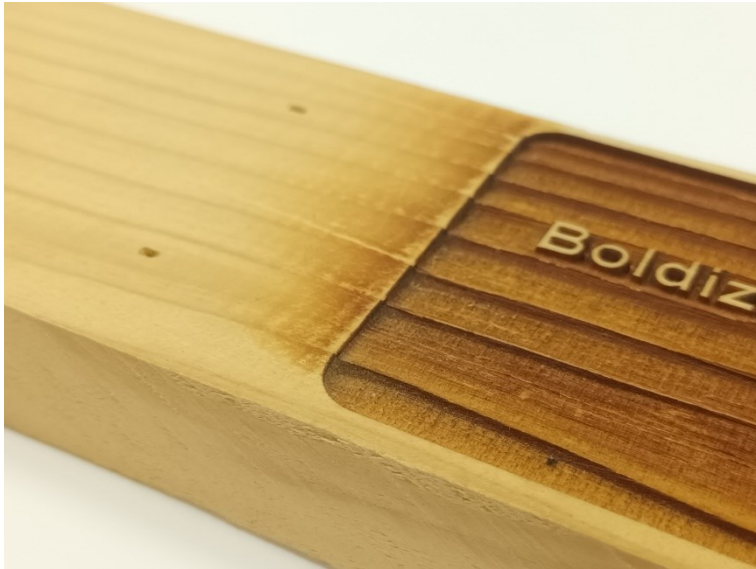
4. ábra: Gravírozott fenyőfelület (kirajzolódó évgyűrűszerkezet)
