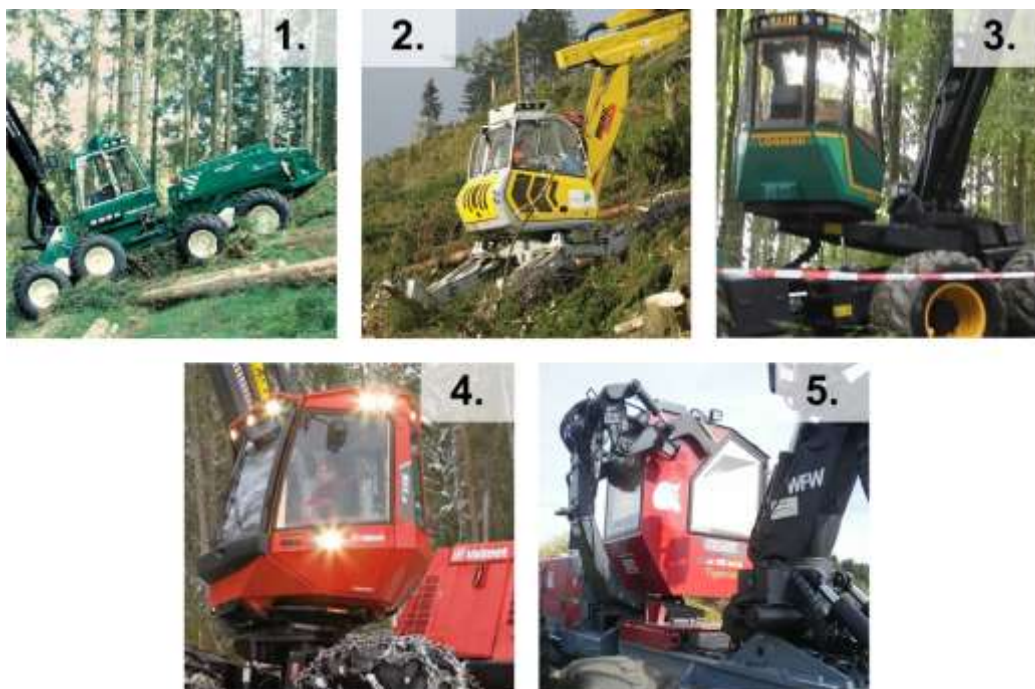
6. ábra: Kezelőfülke szintezése
