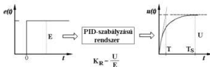
1. ábra: Rendszer időállandók ( T , T_s ) és átviteli tényező ( K_R ) meghatározása dinamikai válaszreakcióból
