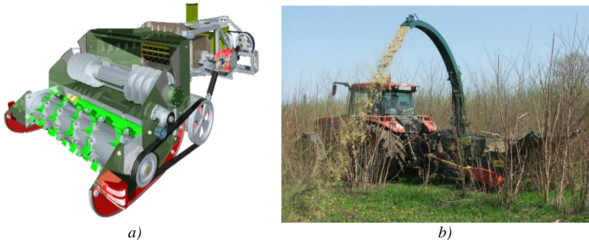
5. ábra: Sorfüggetlen betakarítógép: a) elvi kialakítás; b) az elkészült gép munkában (forrás: Horváth - Kaczor, 2013; Horváth B. 2016)
