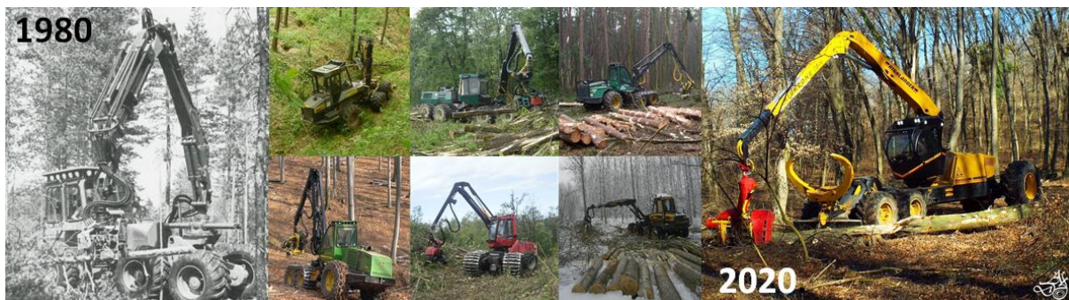
2. ábra. FMG Timberjack-SP21 egyadapteres és napjaink harveszterei
