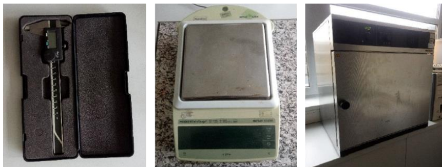
3. ábra. Egyensúlyi nedvességtartalom és sűrűség meghatározásához használt digitális tolómérő, laboratóriumi mérleg és szárítószekrény
