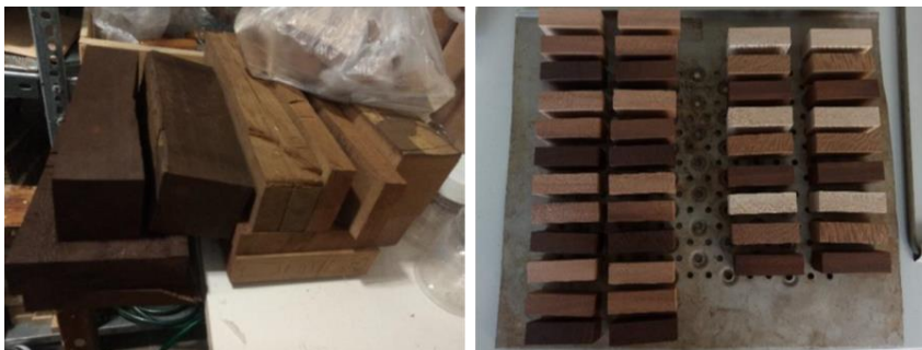
2. ábra. A hőkezelt platán anyagok (bal) és a kialakított próbatestek hármas csoportjai (jobb; belül balra a geszt, jobbra a szijács minták)
