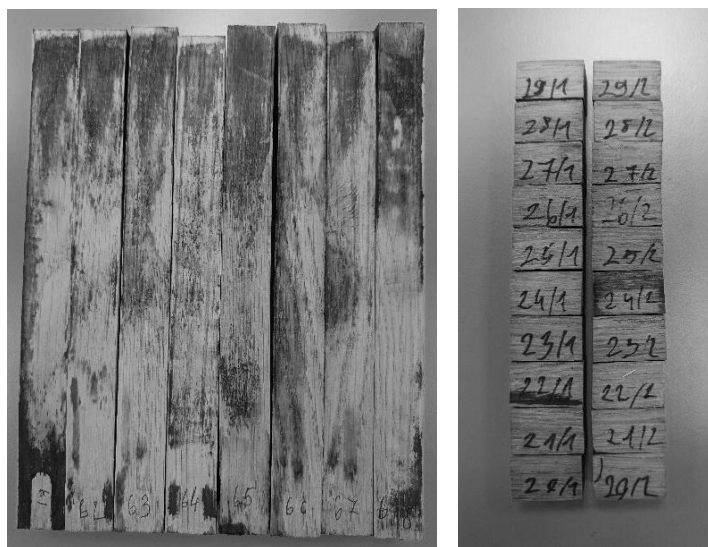
1. ábra. Képek néhány mintadarabról a rostirányú tömörítés után (balra) és a nyomóvizsgálathoz való felfűrészelés után (jobbra)
