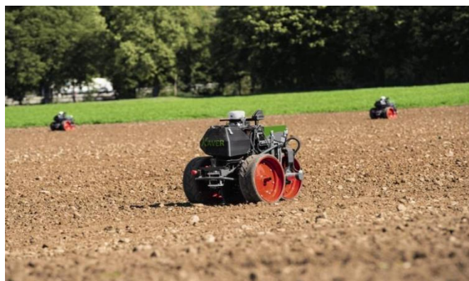
3. ábra. Fendt Xaver szemenkéntvető gép rajban üzemeltetve (Garvey, 2021)
