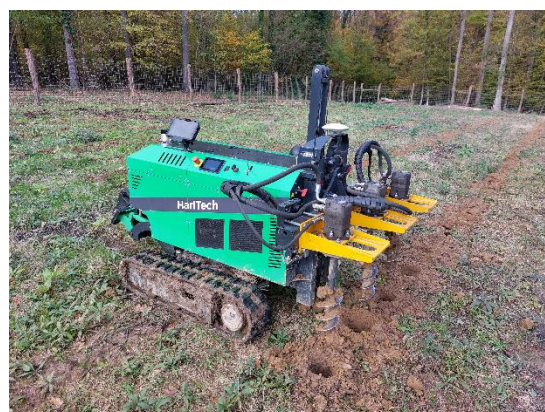
9. ábra. haRiBOT V3 magajáró robot gödőrfúró adapterrel (fotó: Major T.)
