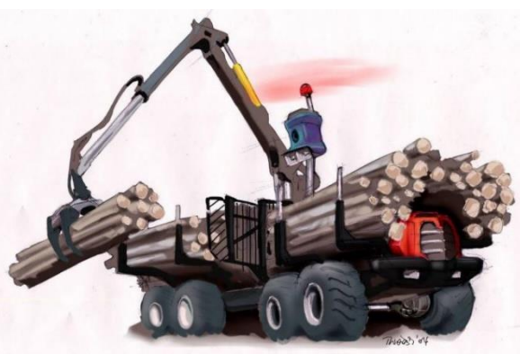
11. ábra. „Okos” hidraulikus darus forvarder elvi kialakítása (forrás: Ringdall, 2011)
