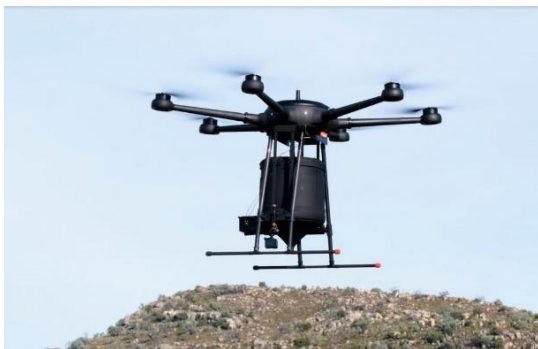
2. ábra. AirSeed vetőszerkezetű drón munkában (forrás: AirSeed Technologies)
