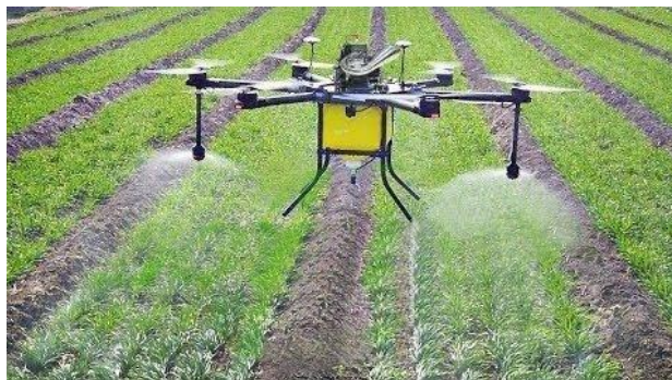
3. ábra. Permetező drón csemetekerti munkában (forrás: Condor Mendoza)
