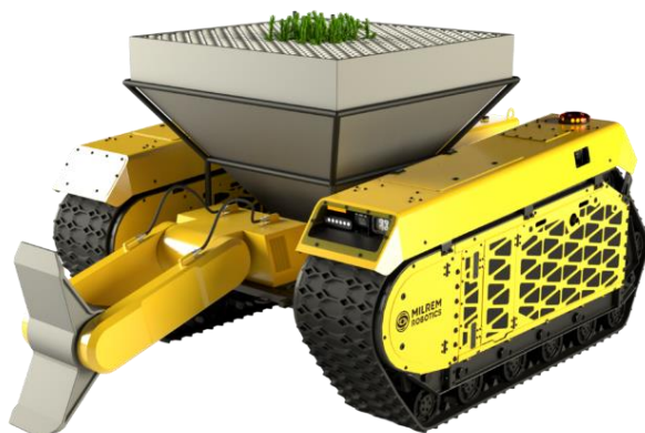
8. ábra. Ültetőrobot talaj-előkészítő résszel (forrás: Milrem AS)
