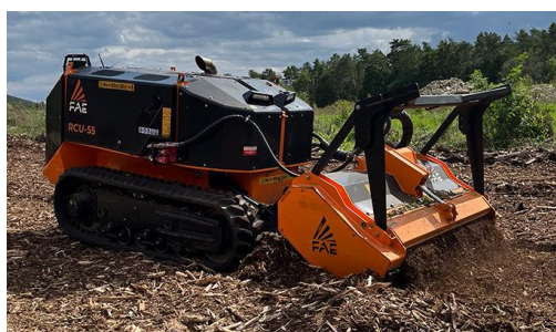
4. ábra: Távírányítású erőgép szárzúzóval. Forrás: https://erdesztetiszarzuok.hu
