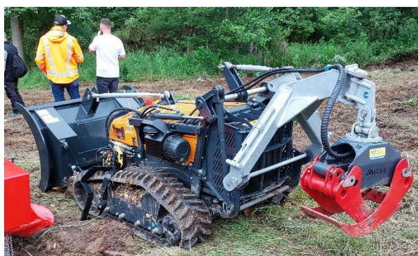
8. ábra: Távírányítású erőgép markolós vonszolóval.
