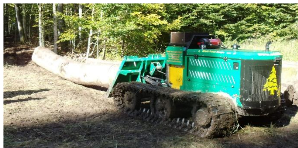
5. ábra: Távírányítású kistraktor csörlővel.
