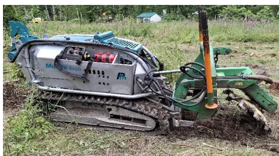
6. ábra: Pásztakészítő hajtott kivitelű tárcsa távírányítású erőgépen.
