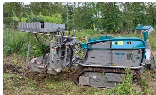
7. ábra: Talaj-előkészítő ültetőgép távírányítású erőgépen.
