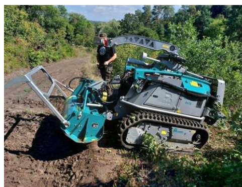
9. ábra: Pfanzelt távírányítású erőgép szárzúzóval és járókerékarányos vontatócsörlővel.
