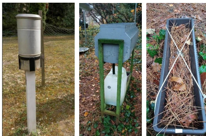
2. ábra: Mérőeszközök a Botanikus Kertben (balról jobbra: Hellmann-féle csapadékmérő, áthulló csapadék mérő kád, effektív csapadék mérőedényzet).
