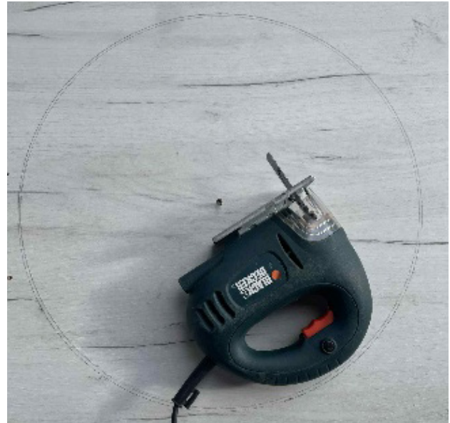
3. ábra. Szabályos kör kivágása dekopírfűrészsel. Forrás: szerző
