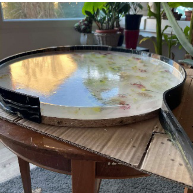
16. ábra. Ezt követte az EPDM gumi leválasztása az öntvény oldaláról. Forrás: szerző
