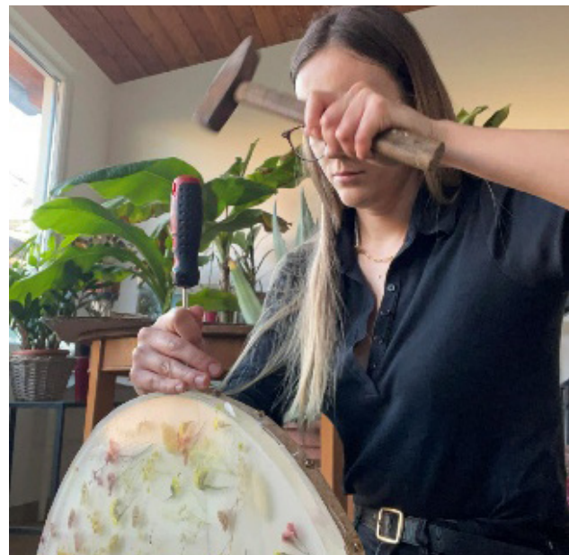
17. ábra. Majd laposfejű csavarhúzóval óvatosan leválasztásra került az öntvény a formáról. Forrás: szerző
