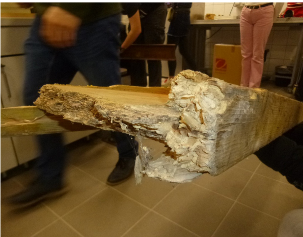
3. ábra. Negyedik fázisú rovarkárosítás a gerenda övelemén. Forrás: szerző
