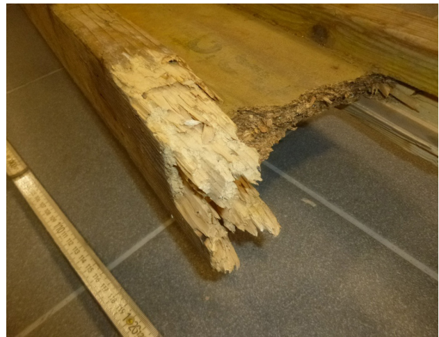
4. ábra. Negyedik fázisú rovarkárosítás a gerenda övelemén. Forrás: szerző
