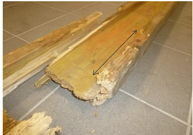
2. ábra. Anyagihiányosság a gerendán, a törés környezetében. Forrás: szerző
