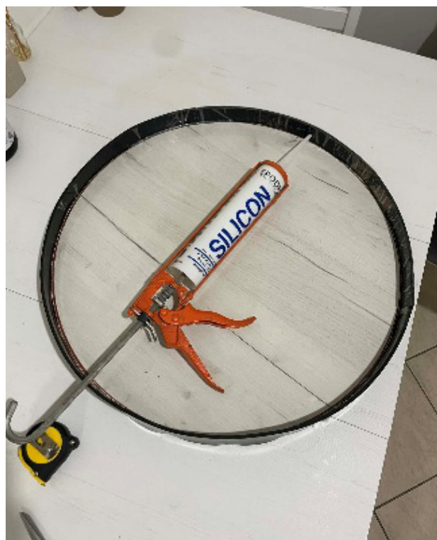
7. ábra. Negatív sarkok kihúzása savmentes szilikonnal. Forrás: szerző
