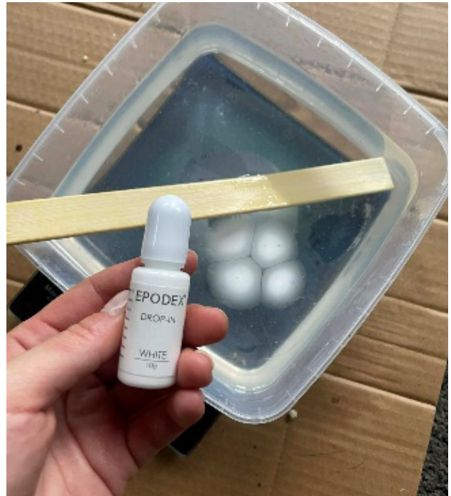
11. ábra. Pigment hozzáadása, majd csíkmentesre keverés. Forrás: szerző
