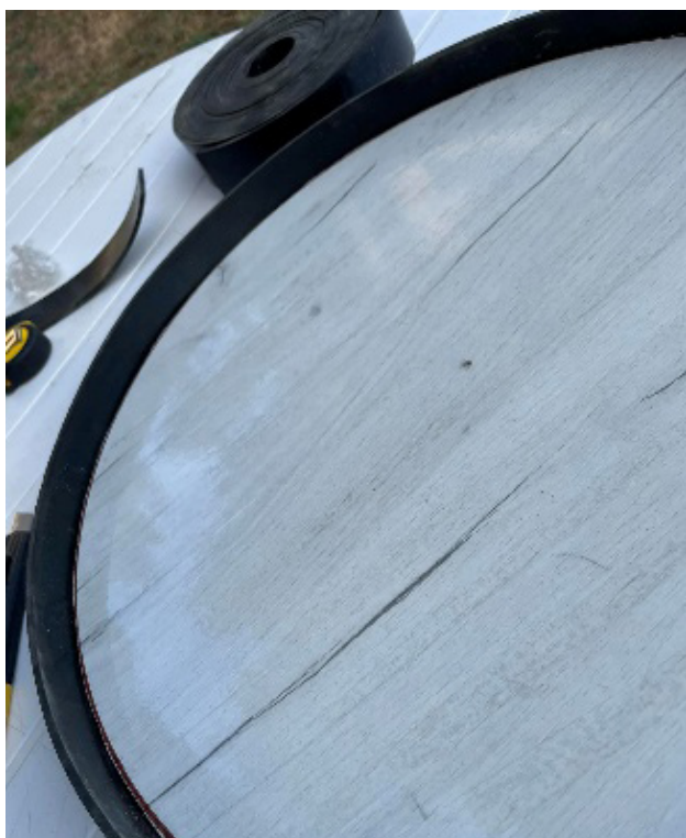
6. ábra. Felcsavarozott szegély. Forrás: szerző
