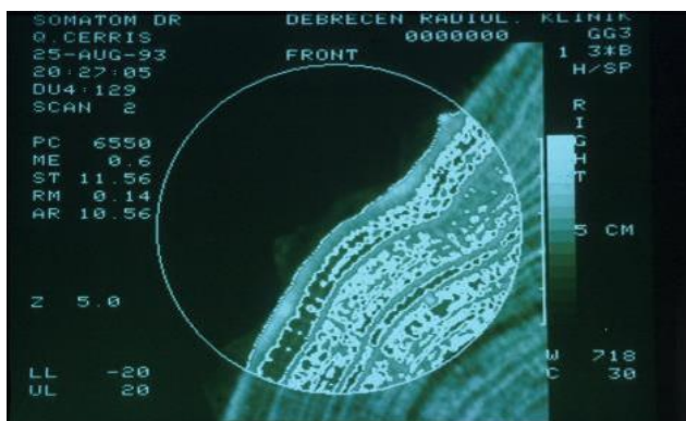
2. kép: Tölgyfa szállító nyalábjainak CT felvétele.
